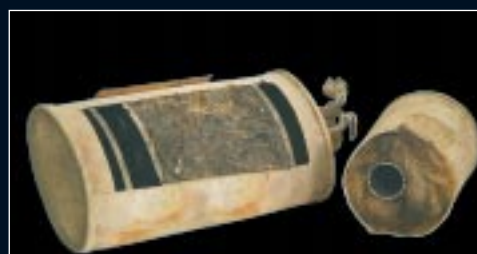
A fibra de vidro “roving” deste silencioso do Volvo 780, preenchido com o sistema de controle de ruído Silentex da Owens Corning, praticamente não foi afetada após seis anos de uso e rodando 270 000 km.
